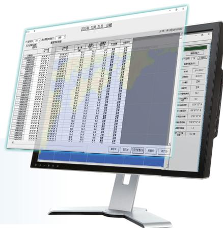
ブイテレメータシステムは、洋上の浮体（ブイ）に機器を搭載し、「海水温、流向・流速、風向・風速などの海気象データの収集」および、「浮体位置、灯火、電源電圧など保守情報の監視」を行い、衛星通信を使用して、陸上設備へデータを伝送します。陸上設備では、電話応答装置によるテレホンサービスやホームページにより情報提供することができます。
