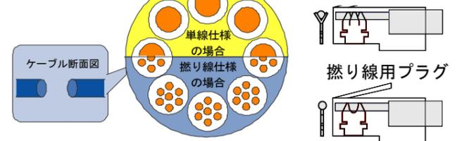
❗ 単線ケーブルに撚り線用プラグを使用すると圧着不良になります！
