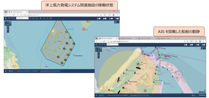
図7 “MAP”による船舶動静および洋上風力発電システム関連施設の稼働状態の表示例 Fig.7 Display example of ship movement and operating status of offshore wind power generation system-related facilities using “MAP”
