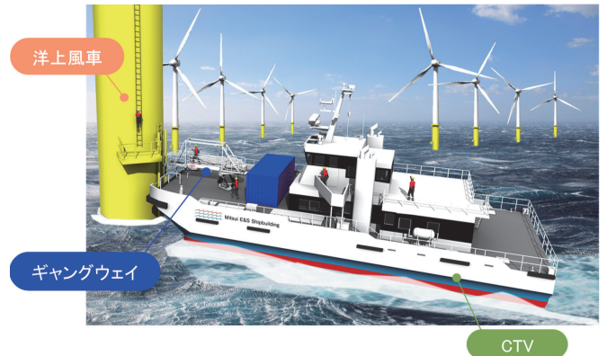
図1 CTVから洋上風車への移乗の様子
