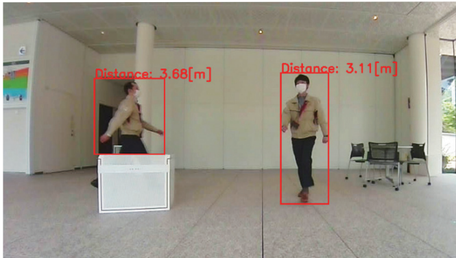
図5 物標（人物）に対するバウンディングボックス（外周矩形）と概算距離の検出結果
