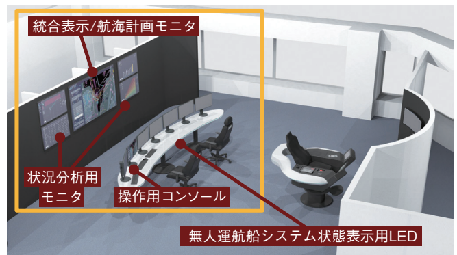
(a) FOCコンセプト 統合表示ブロック (枠線内) (a) FOC concept: Monitoring block (inside the frame)
