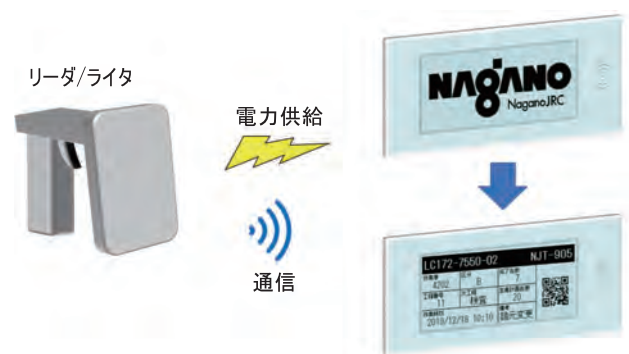
図9 電子ペーパータグの書き換えイメージ
