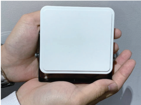
図1 周辺監視レーダ
