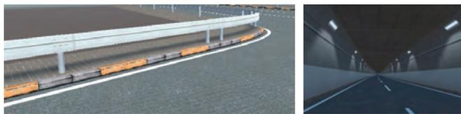
図13 自動生成した縁石、ガードレール、歩道、トンネルの3D描画例
