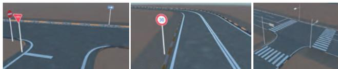
図14 自動配置した標識、信号の3D描画例
