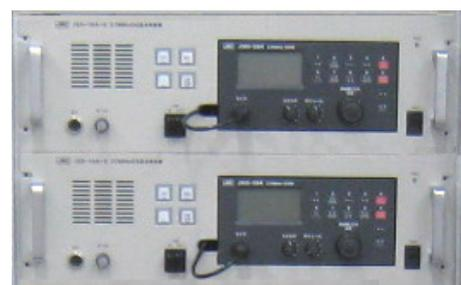
図7 27MHz帯DSB送受信装置の外観
