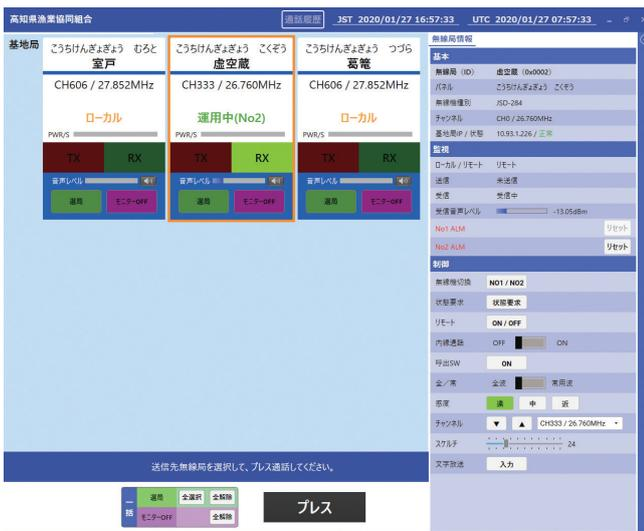
図11 27 MHz帯DSB管制器操作画面
