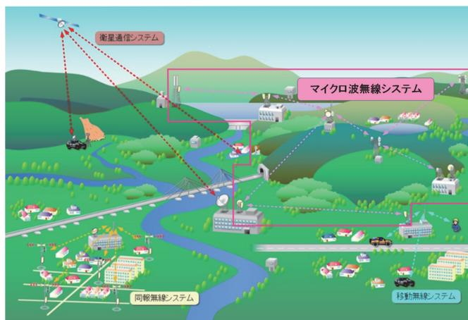
図1 マイクロ波無線システムにより高度化された防災通信システム
