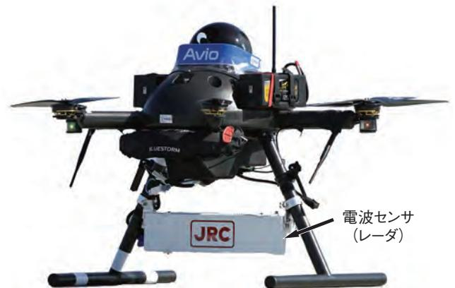
図7 小型化・低消費電力化した電波センサ（レーダ）を搭載した小型無人航空機
