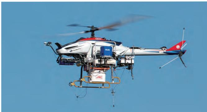
図1 センサを搭載した中型無人航空機
