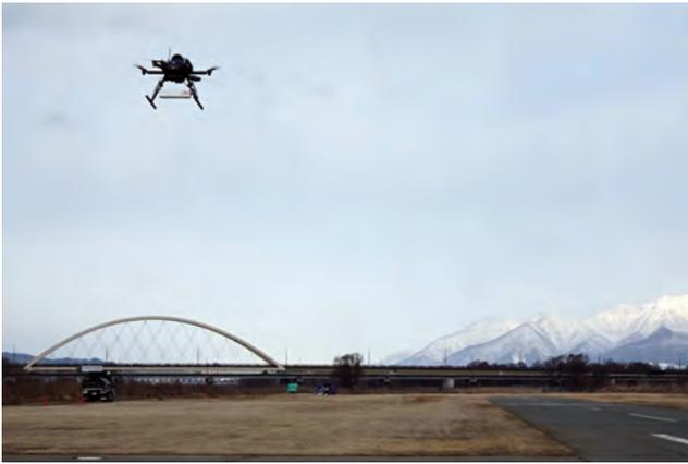
図8 小型無人航空機に電波センサ（レーダ）を搭載した動作試験の様子
