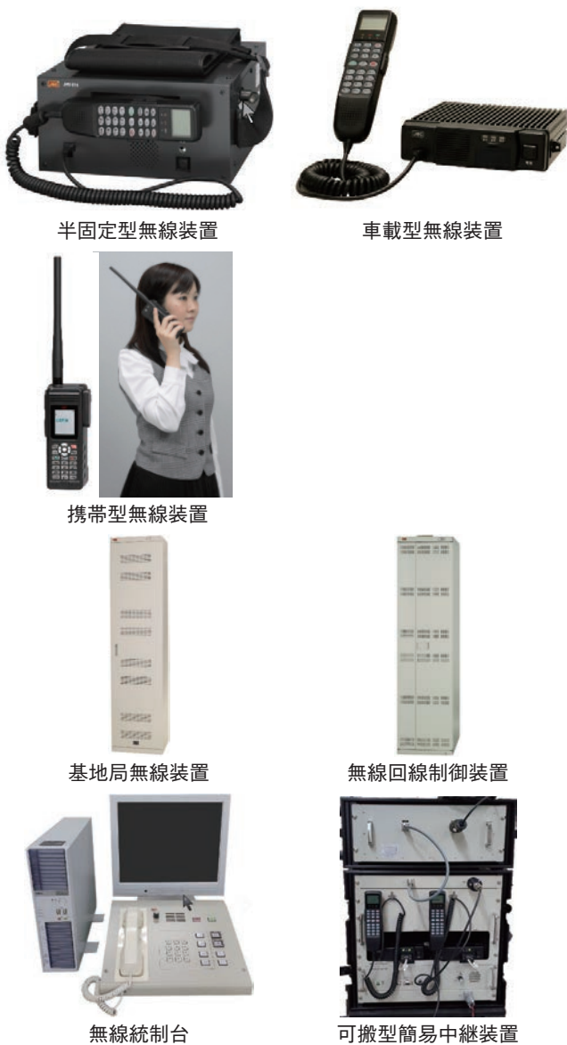
図4 都道府県・市町村デジタル移動無線システムを構成する装置
