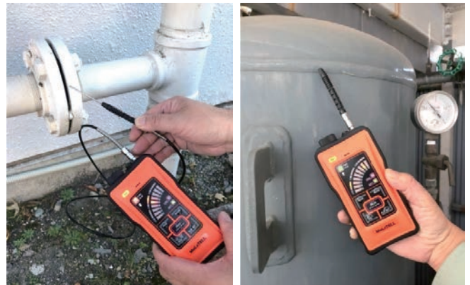
図3 吸引式によるガス漏れ箇所検知の様子
