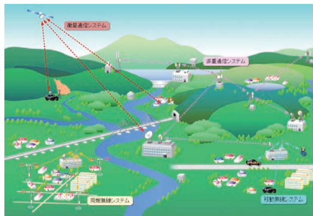
図2 災害対策用無線通信ネットワークの構成例
