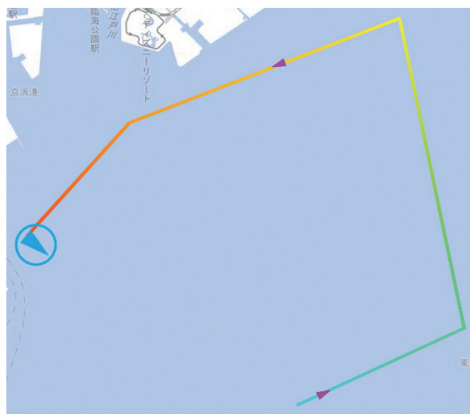
図6 航跡上の水温データ重畳表示の例 (拡大図) Fig.6 Example of display superimposing water temperature data on the trails (Enlarged view)
