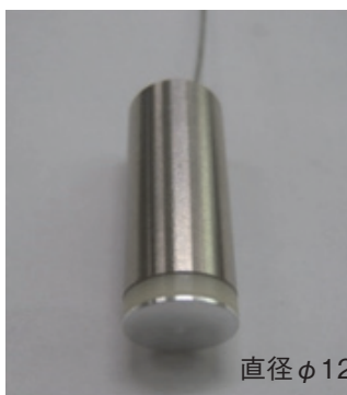
図3 ポーラスPZT振動子を用いた超音波プローブ
