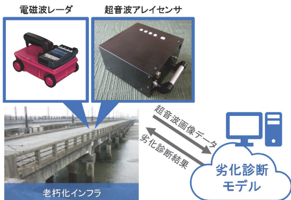
図5 超音波アレイセンサによる劣化診断システムの概念図
