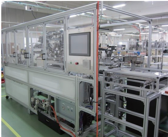
図5 第3世代トロイダルコイル全自動巻線機 Fig.5 3rd generation toroidal coil fully automatic winding machine
