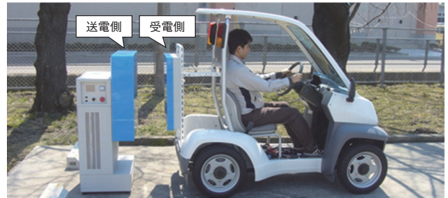
図7 1kWワイヤレス電力伝送デモシステム Fig.7 1kW WPT Demonstration System
