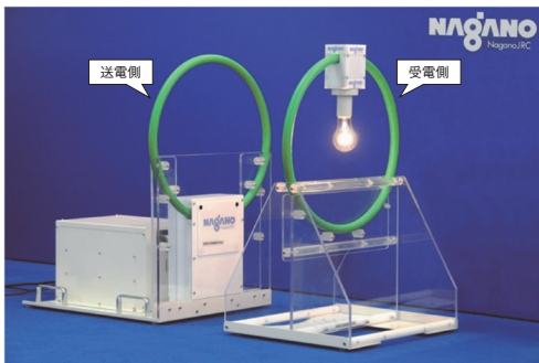
図6 原理実証機 (30W) Fig.6 30W WPT Principle Proof Model
