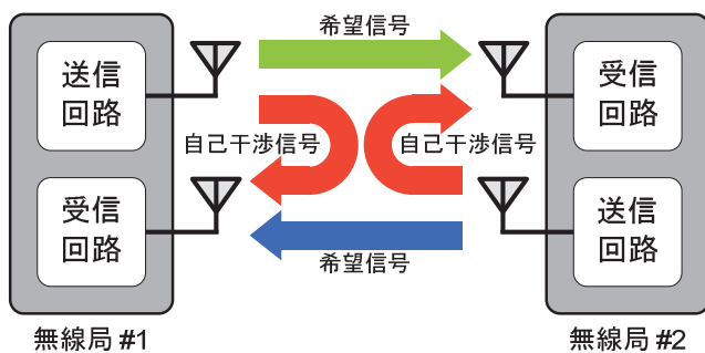
図2 DDD方式における自己干渉信号 Fig.2 Self-interference signal in DDD
