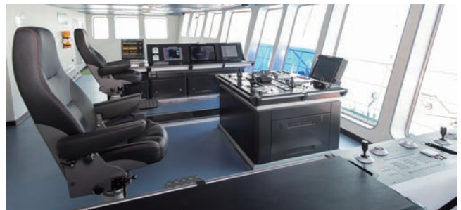
作業区画側ブリッジコンソール Aft Bridge Console
