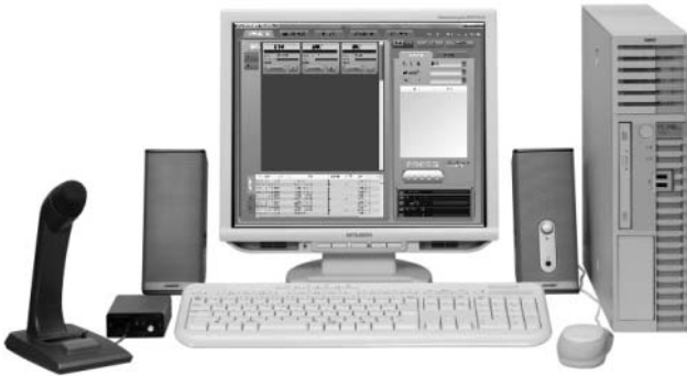
図2 監視制御操作コンソール
