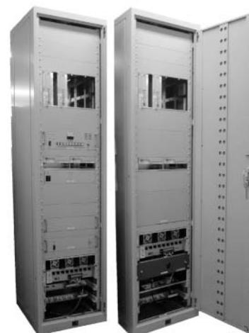
図6 ラジオ再放送システムの外観 (新型機)
