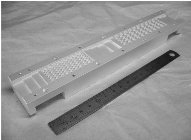
図3 ワッフルアイアンフィルタの構造例 Fig.3 Realization of a waffle iron filter
