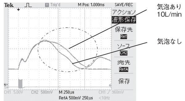
図4 空気流入量10L/min時の反射波形
