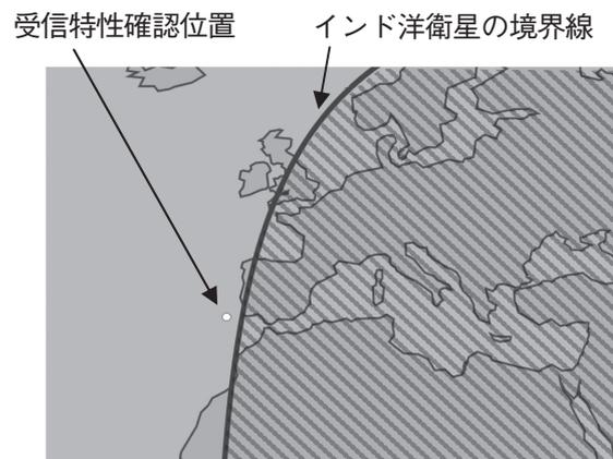
図8 受信特性確認位置の例（対インド洋衛星, IOR）
