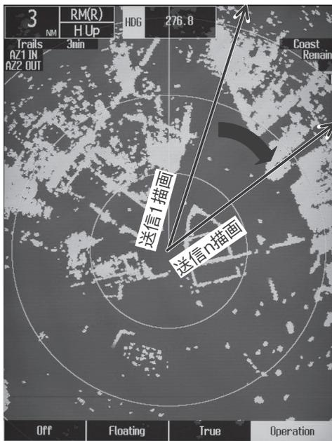
図6 直交座標系信号処理
