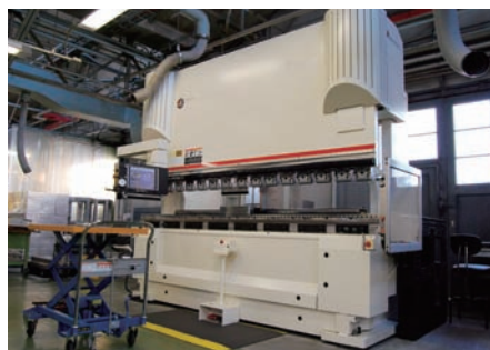
図9 ハイブリッドプレスブレーキ Fig.9 Bending machine with hybrid drive system installed
