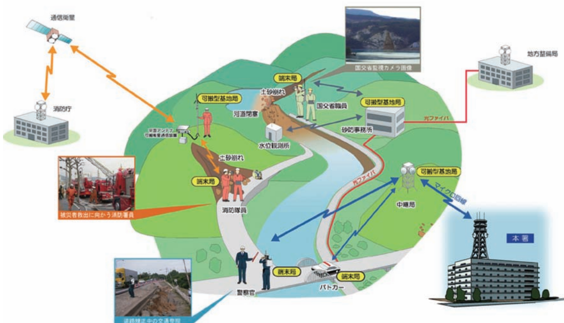
図6 共ブロードバンド移動通信システム概念図 (可搬型)
