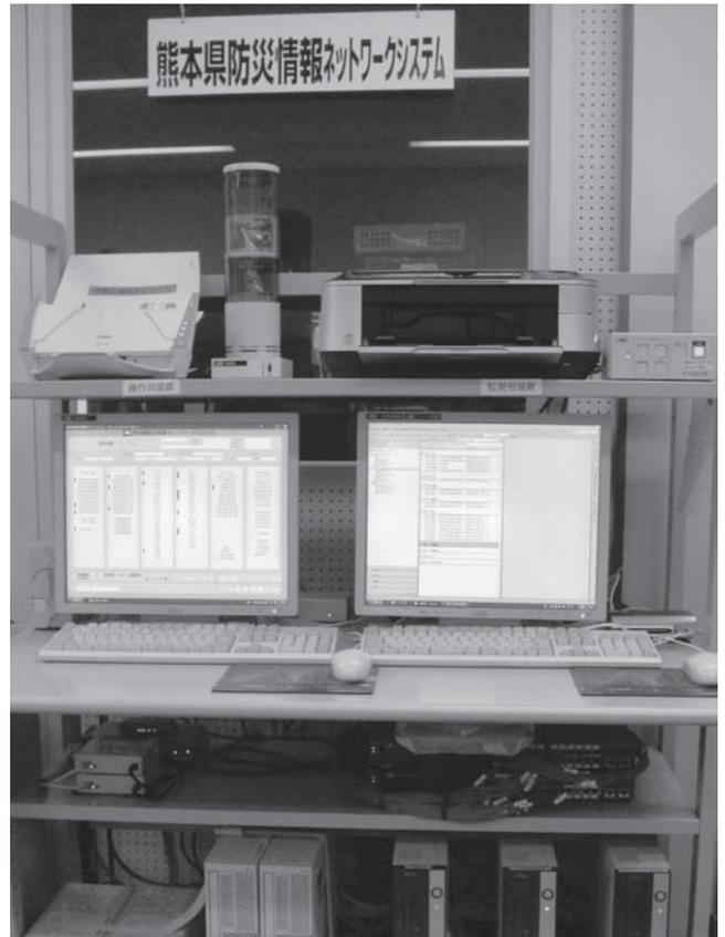
図3 統制端末と一斉受令制御装置
