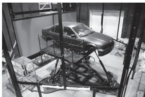
動揺装置、模擬車両、スクリーンフレーム Shaking apparatus, mock vehicle, screen frame
