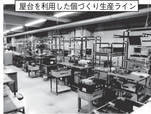
図6 従来の生産ラインと個づくり生産ライン
