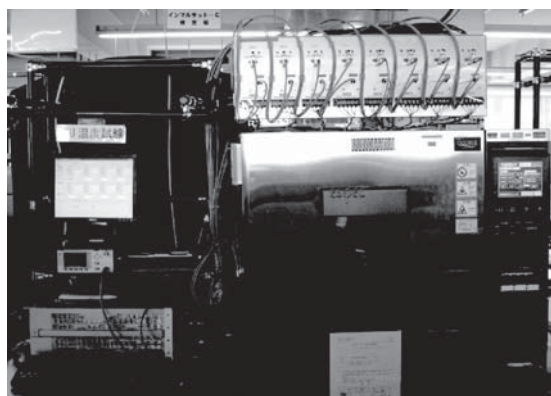
図9 ADU/BDE自動温度特性検査装置
