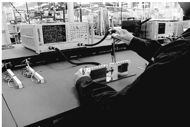
図5 フィルタ部の調整作業 Fig.5 Filter Tuning
