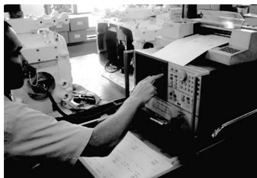
図14 VSWR測定検査の状況
