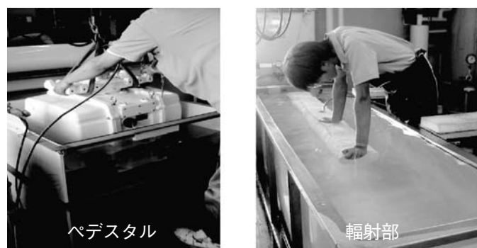
図15 ベデスタルと輻射部の防水試験
