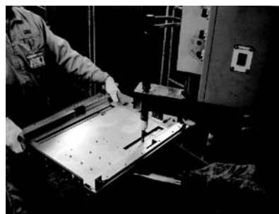
図10 スポット溶接作業
